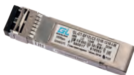
GL-OT-SF12LC2-1310-1310-I-M Промышленный SFP, 100 Мбит/с, два волокна MM, 2xLC, 1310 нм, 12 дБ, 2 км
