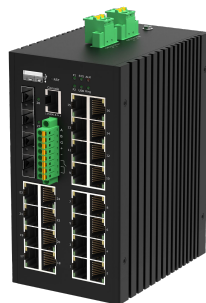
GL-SW-G307-24P4ST-I(BT) 24 основных портов 1000 Мбит/с (стандарт PoE (af/at/BT) - 4 BT-порта, 4 x 10G SFP+
